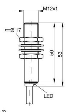
Induktiver Näherungsschalter BES M12MI-PSC40B-BP03 M12x1 x 53 Schließer Sn=4mm bündig einbaubar
